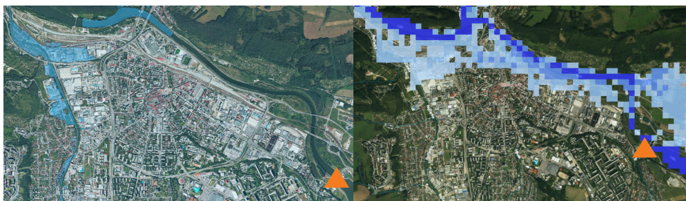
Obrázok 1: Povodňové ohrozenie Q100 v Žiline podľa RPI a CEMS.
